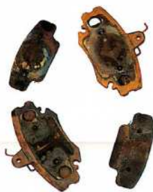
Изначально тормозные колодки и их прижимные пластины на Sandero составляли единое целое
