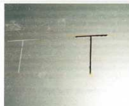
После очередных посещений коррозионной камеры влияние соляного тумана по-прежнему заметно только у Hyundai — в местах надрезов краски на крыше
