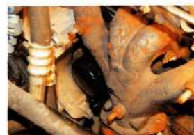
Масляный фильтр у Sandero расположен очень неудобно — вплотную к выпускному коллектору (на фото экран коллектора снят)
