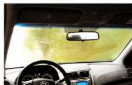
При высокой влажности без включенного кондиционера ветровое стекло Соляриса запотевает полностью
