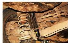
Внешне новые, более жесткие задние амортизаторы Mando отличаются от прежних желтой меткой и последней цифрой кода (1 вместо 0)
