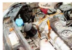
На Polo масляный фильтр установлен так, что лучше не придирайтесь
