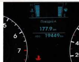
Есть перегрев! На шкале термометра Соляриса еще осталось незаполненное деление, но пиктограмма сообщает о недопустимой температуре охлаждающей жидкости: 122–127 градусов
