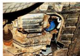
У Соляриса масляный фильтр доступен только снизу, но менять его гораздо удобнее, чем на Sandero
