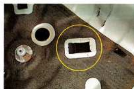
В двух из четырех мест упора запасного колеса в металлическое дно ниши багажника образовались сквозные трещины длиной 5–6 см
