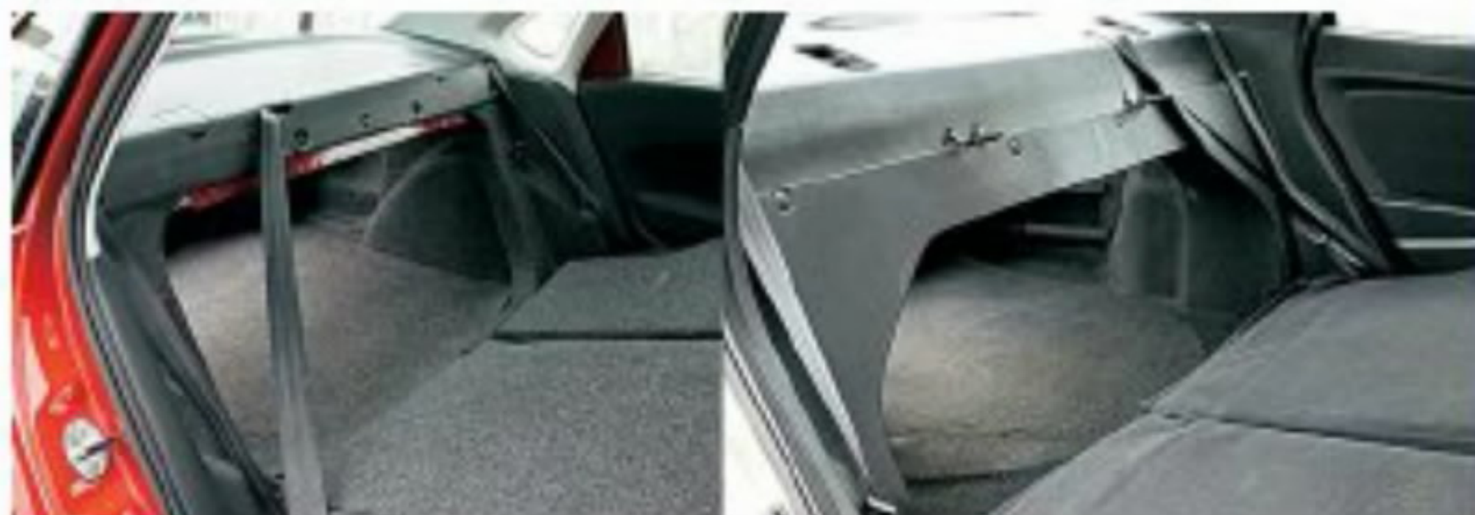
Спинки задних сидений обеих машин при необходимости легко откидываются, но ширину проема ограничивают «калибровочные» окна.
